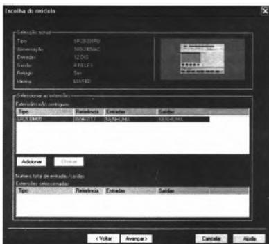
Figura A.4 - Expansões possíveis para o módulo Zelio Logic.
