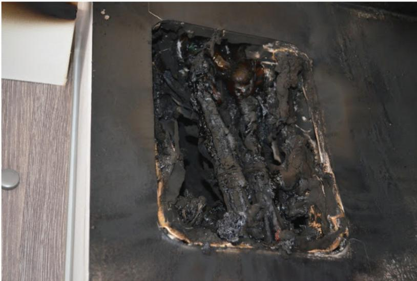
O mal dimensionamento dos condutores e disjuntores e a falta de proteção é um dos principais causa de incêndios em instalações elétricas.
